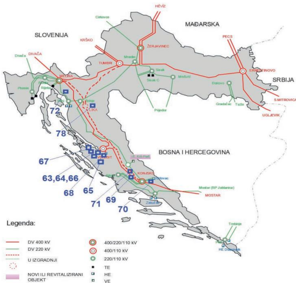
Slika 17. Prijedlog hrvatskog HOPS-a izgradnje energetske prstena 400 kV te 220 kV mreže te ojačanje Konjско-Melina 23
